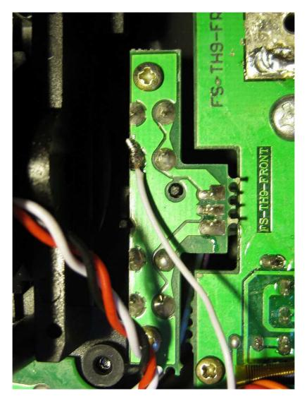
passiamo all'altro stick: pulsante prima del taglio, notate bene la protuberanza di circuito che finisce sotto il pulsante e il ponticello che va sulla piazzola della saldatura
