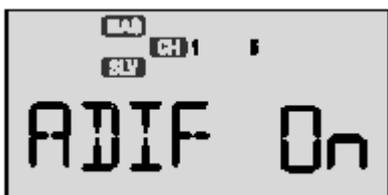
7 Assicuratevi di collegare il servo alettoni destro al **canale 1** ed il servo alettoni sinistro al **canale 5** del ricevitore.
