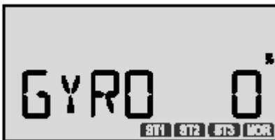
2 Per impostare il valore per la condizione di volo **NOR**, spostate l'interruttore **SW4 Fit.Mode** tutto in **avanti**. La scritta **NOR** lampeggerà. Impostate la percentuale di sensibilità del giroscopio, usualmente valori abbastanza elevati. Se volete tornare rapidamente a 0 premete il tasto **Active/inhibit (Clear)**
