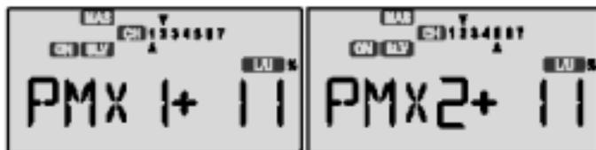
Usate la miscelazione libera **PMX2** per impostare in modo analogo la miscelazione tra elevatore **Ch2** master ed alettone sinistro **Ch5** slave. E' estremamente importante che i due alettoni si muovano esattamente con la stessa corsa quando attivate la miscelazione (corse diverse farebbero logicamente funzionare i flapperoni come alettoni e farebbero virare il modello)
