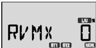
2 premete il tasto **+ Data Increase**. Questo aumenterà la percentuale di **RVMX** per la parte bassa della curva del gas; potete impostare valori tra 0% e 100% per questo lato della corsa. Potete tornare rapidamente a 0% premendo il tasto **Clear (Active/Inhibit)**.
