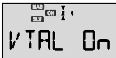
5 Se la parte mobile sinistra si fosse mossa verso il basso, potete cambiare il suo senso di moto premendo una volta il tasto **freccia a destra** (la freccia sotto si muove sotto il numero 4 ad indicare che state modificando la corsa per il CH4, parte mobile sinistra).
