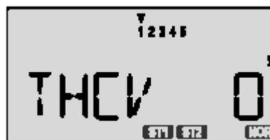
4 Quando avete finito con il punto 1, passate al punto 2 premendo il tasto **freccia a destra**. Una piccola freccia sopra il display indica il numero 2. inizialmente la miscelazione del punto 2 è inibita (INH). Se la lasciate così (INH) la curva sarà lineare dal punto 1 al punto 3. Se volete modificare il valore, usate i tasti **+ Data increase** e **- Data decrease**.
