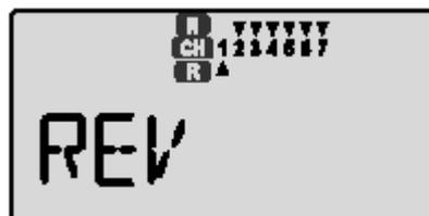
13 Adesso sistemeremo la corsa dell'elevatore, canale 2. Quando muovete lo stick dell'elevatore verso il **basso** la parte mobile dell'elevatore deve muoversi verso l'**alto**. Controllate che il servo si muova nella direzione corretta (una considerevole parte dei modelli viene rotta a causa di comandi invertiti).
