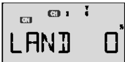
**Nota : inizialmente provate ad attivare la funzione LAND a quota di sicurezza e volando a velocità media. Controllate che anche a bassa velocità non ci siano problemi di assetto o di perdita di autorità di controllo da parte degli alettoni.**
