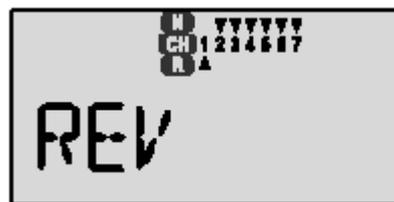
18 adesso sistemeremo la corsa dell'elevatore, canale 2. Quando muovete lo stick dell'elevatore verso il basso la parte mobile dell'elevatore deve muoversi verso l'alto. Controllate che il servo si muova nella direzione corretta (una considerevole parte dei modelli viene rotta a causa di comandi invertiti).
