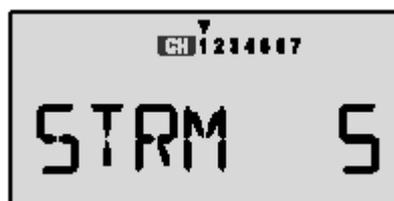
**25** regolare l'alettone destro per primo. Se la piccola freccia non sta indicando il canale 1 premere il tasto cursore destro o sinistro (**freccia destra o sinistra**) fino a che la freccia non indicherà il canale 1 come nella figura sopra. Regolate quindi il subtrim del canale 1 usando i tasti **Data + Increase** o **- Decrease**. Quando l'alettone è perfettamente allineato avete finito.
