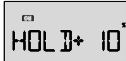
3 Controllate che il comando motore vada nella posizione Hold desiderata spostando l'interruttore (prescelto) selected on-off da una parte all'altra. Regolate i numeri secondo necessità. Assicuratevi di scegliere un regime di giri del motore alto abbastanza per non rischiare spegnimenti accidentali ma basso abbastanza per non impegnare la frizione del rotore principale.
