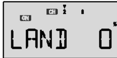
3 Adesso programmate la corsa dei flap Ch6. Premete il tasto **freccia a destra** fino a che la piccola freccia sia sopra il numero **6**. Potete regolare la corsa con i tasti **(+)** e **(-)** impostando un valore qualsiasi tra -100% e +100%.
