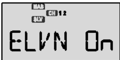
4 Premete una volta il tasto **freccia a destra** per arrivare al menù di impostazione della corsa del comando elevatore. Il piccolo cursore a freccia apparirà sopra il numero 2 ad indicare che stiamo regolando la corsa per la funzione elevatore e il simbolo % lampeggerà per indicare che con i tasti (+) e (-) potete regolare la corsa
