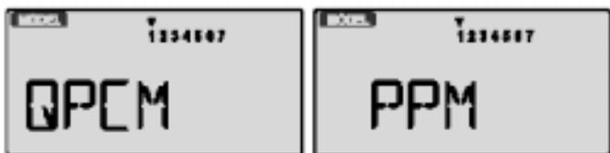
3 PPM è il modo per le riceventi in FM e permette di usare riceventi Hitec (o di altre marche). QPCM è il modo per le riceventi Hitec in QPCM (le riceventi di altre marche in PCM
