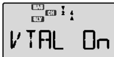
6 Premete una volta il tasto **freccia a destra** per arrivare al menù di impostazione della corsa del comando deriva. Il piccolo cursore a freccia apparirà sopra il numero 4 ad indicare che stiamo regolando la corsa per la funzione deriva e il piccolo cursore a freccia sotto il numero 4 indica che stiamo regolando la corsa del servo della parte mobile sinistra, Ch4
