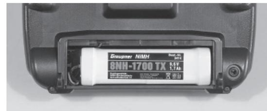
staccate lo spinotto dell'accumulatore, tirando con attenzione il cavo di collegamento o usando l'unghia di un dito. Tirate poi lo spinotto, ma non da sopra a sotto, ma possibilmente in direzione parallela alla superficie superiore della trasmittente.
