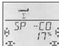
Portare l'elemento di comando per Gas/Spoiler in posizione motore massimo/Spoiler alzati e, con il regolatore digitale 3D, impostare il valore desiderato. Le impostazioni sono subito visibili sul modello.
