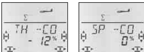
Portare l'elemento di comando per Gas/Spoiler in posizione motore massimo/Spoiler alzati e, con il regolatore digitale 3D, impostare il valore desiderato. Le impostazioni sono subito visibili sul modello.
