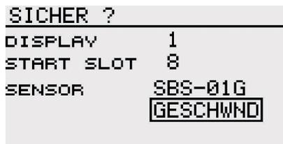
Bei einem Multisensor, z.B. GPS-F1675, können mehrere Sensorwerte gleichzeitig angezeigt werden:
