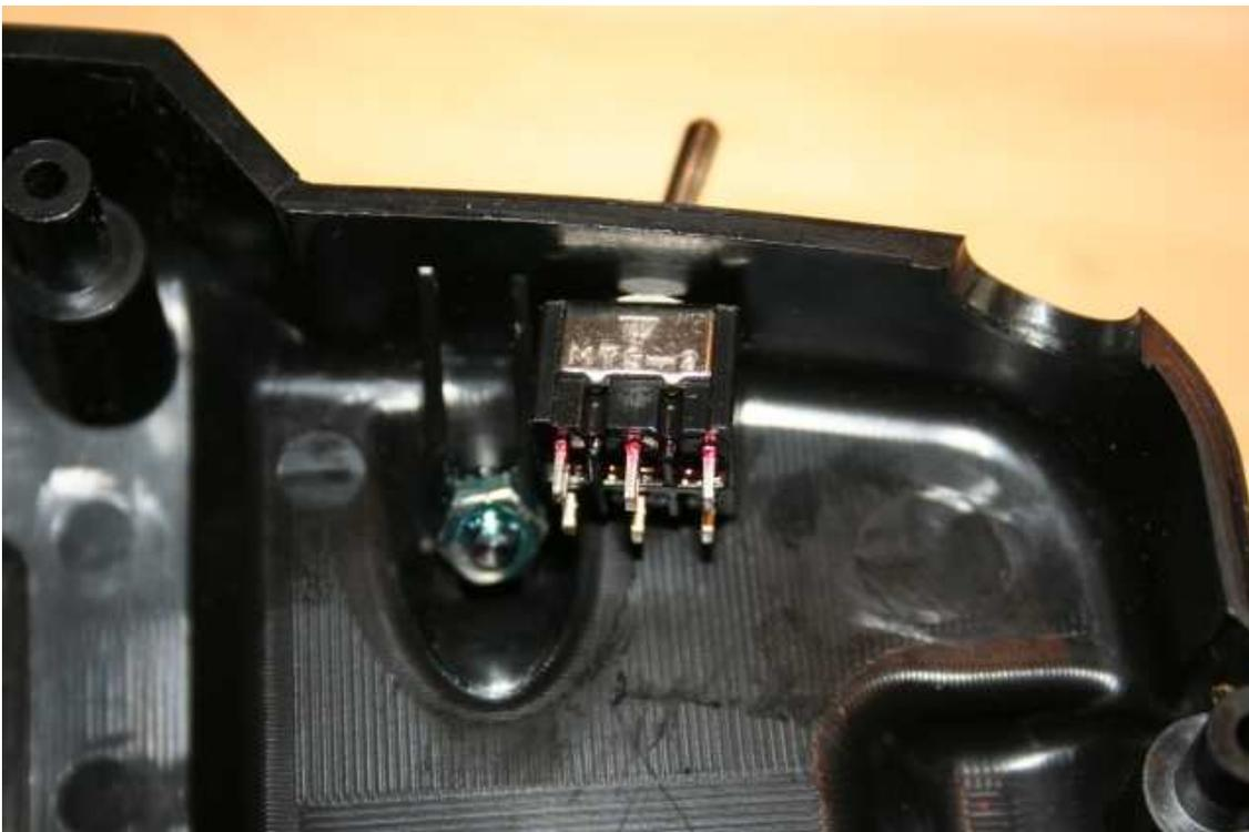
Non è necessario in questo momento stringere il controdado che terrà fermo il deviatore : sarà sufficiente posizionare il deviatore in sede e riproporre le due metà della radio per verificare che non interferisca con altri componenti.
