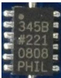
**Figura 16 L'accelerometro**
