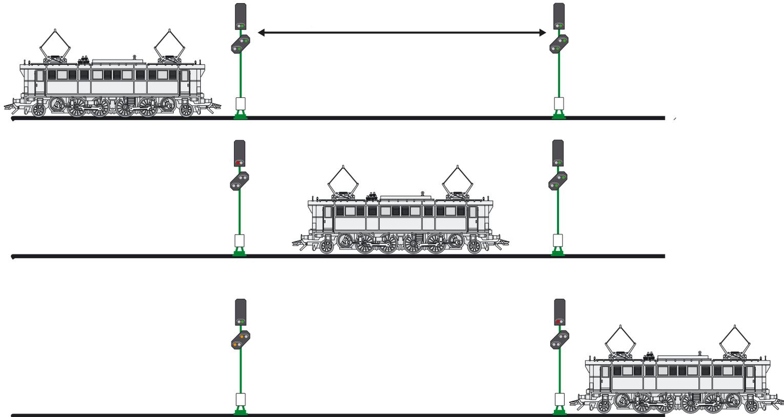
Die Lok fährt bei „Fahrt“ in den Block ein (oben). Sobald sie das Signal passiert hat, schaltet es auf Zughalt (Mitte). Nach Verlassen schaltet das Signal wieder auf „Fahrt“, das Signal für den Folgeabschnitt schaltet auf „Zughalt“ (unten).
