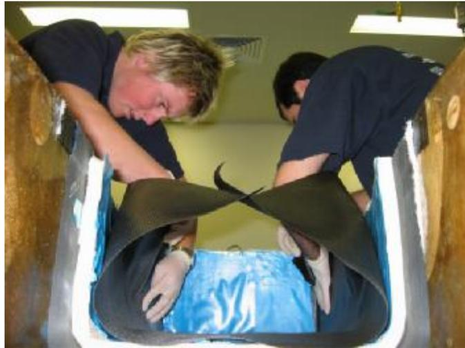
Quando si è sicuri della completa impregnazione del primo tessuto si adagia il secondo e si procede allo stesso modo. Questa volta l'operazione è più veloce, si apporta una minor quantità di resina in quanto il tessuto assorbe l'eccesso del primo strato. Si prosegue così, in modo continuo, bagnato su bagnato, fino ad ultimare la stratificazione.
