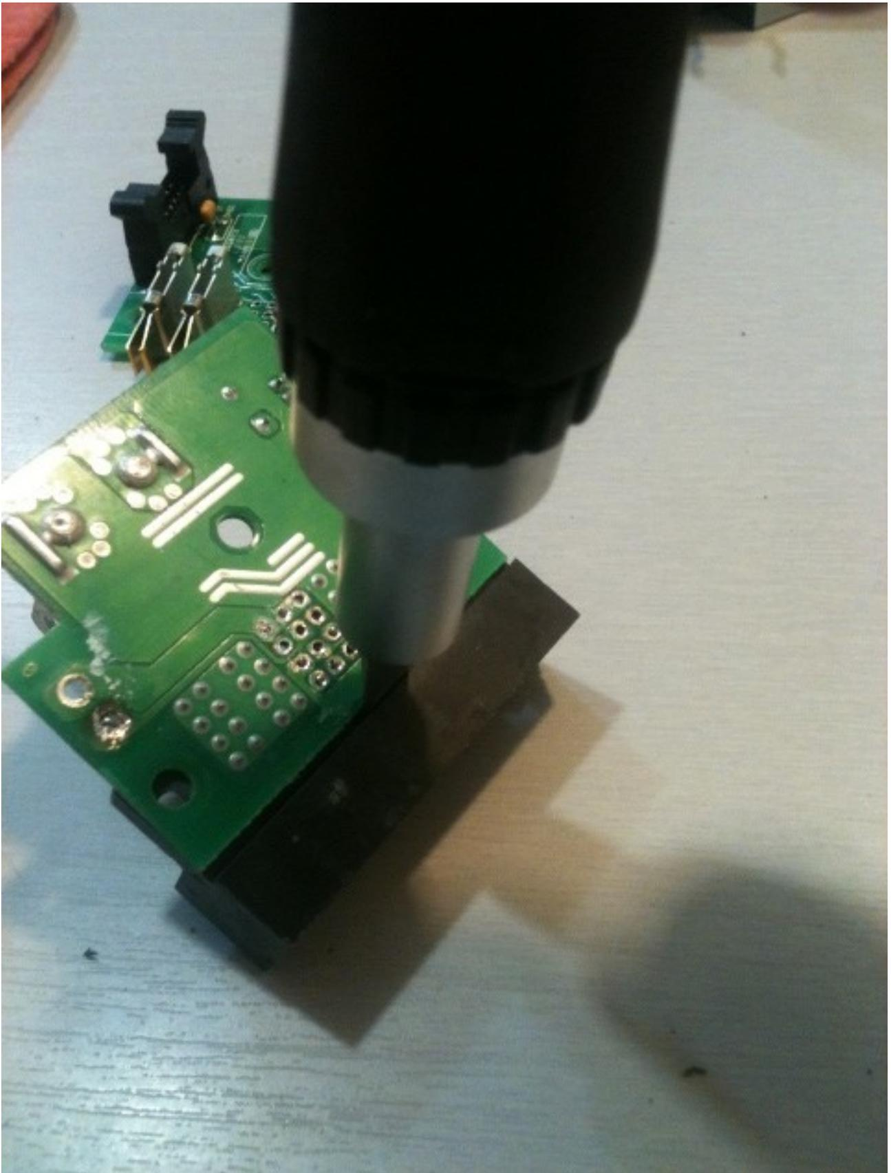
Con un cacciavite piatto e molta calma fate leva per sfilare completamente il connettore
