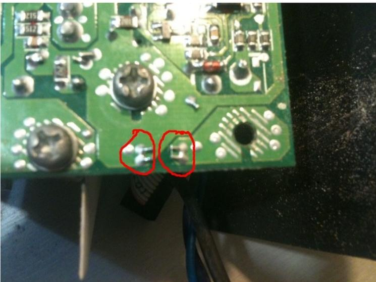
Per la vite destra invece è necessario rimuovere con una fresetta piccola il rame dallo stampato (entrambi i lati) come nelle foto seguenti
