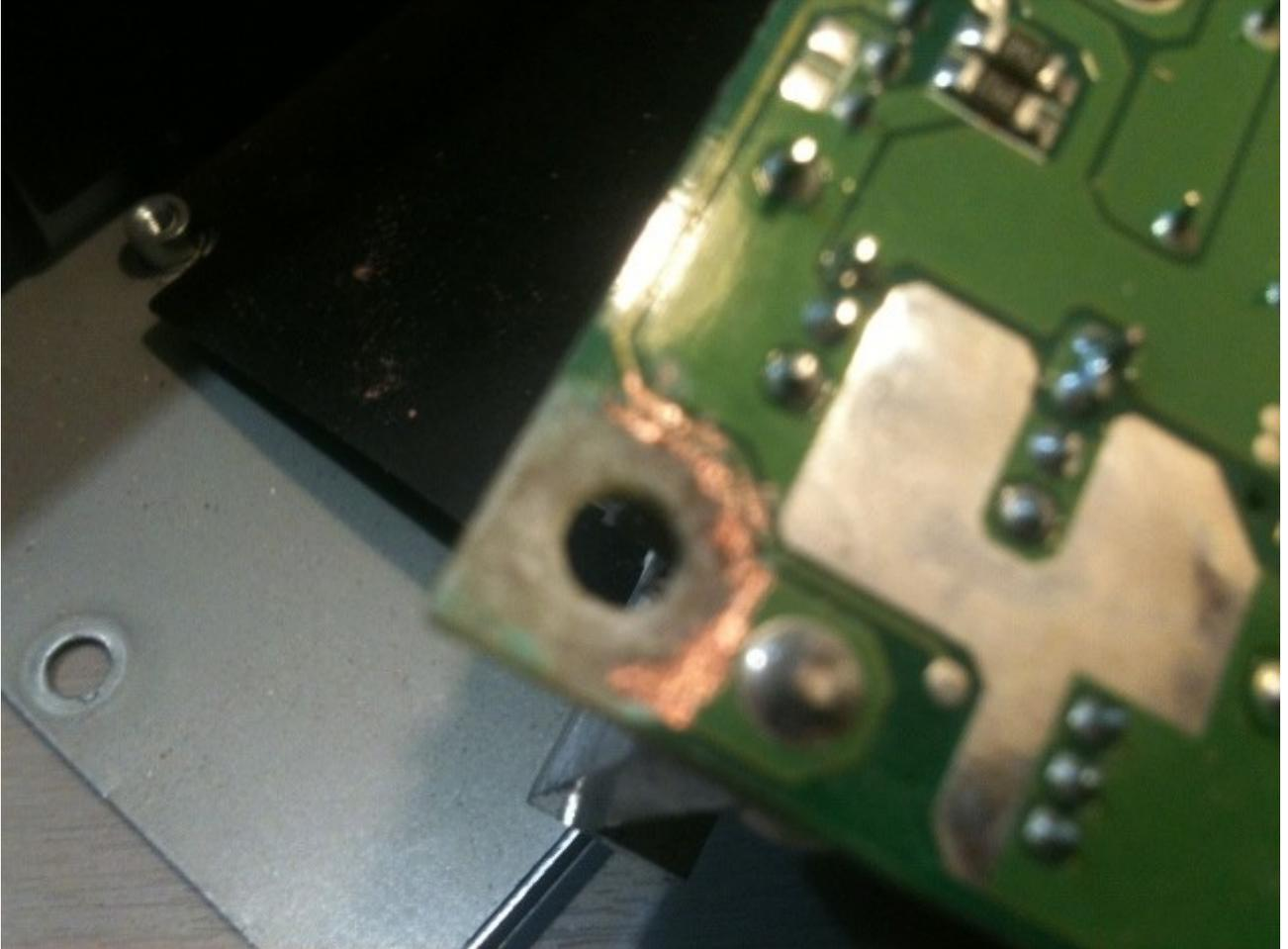
Una volta preparato il tutto si possono saldare dei bullet da 4 mm fra le lamelle ed effettuare la ponticellatura del connettore.
