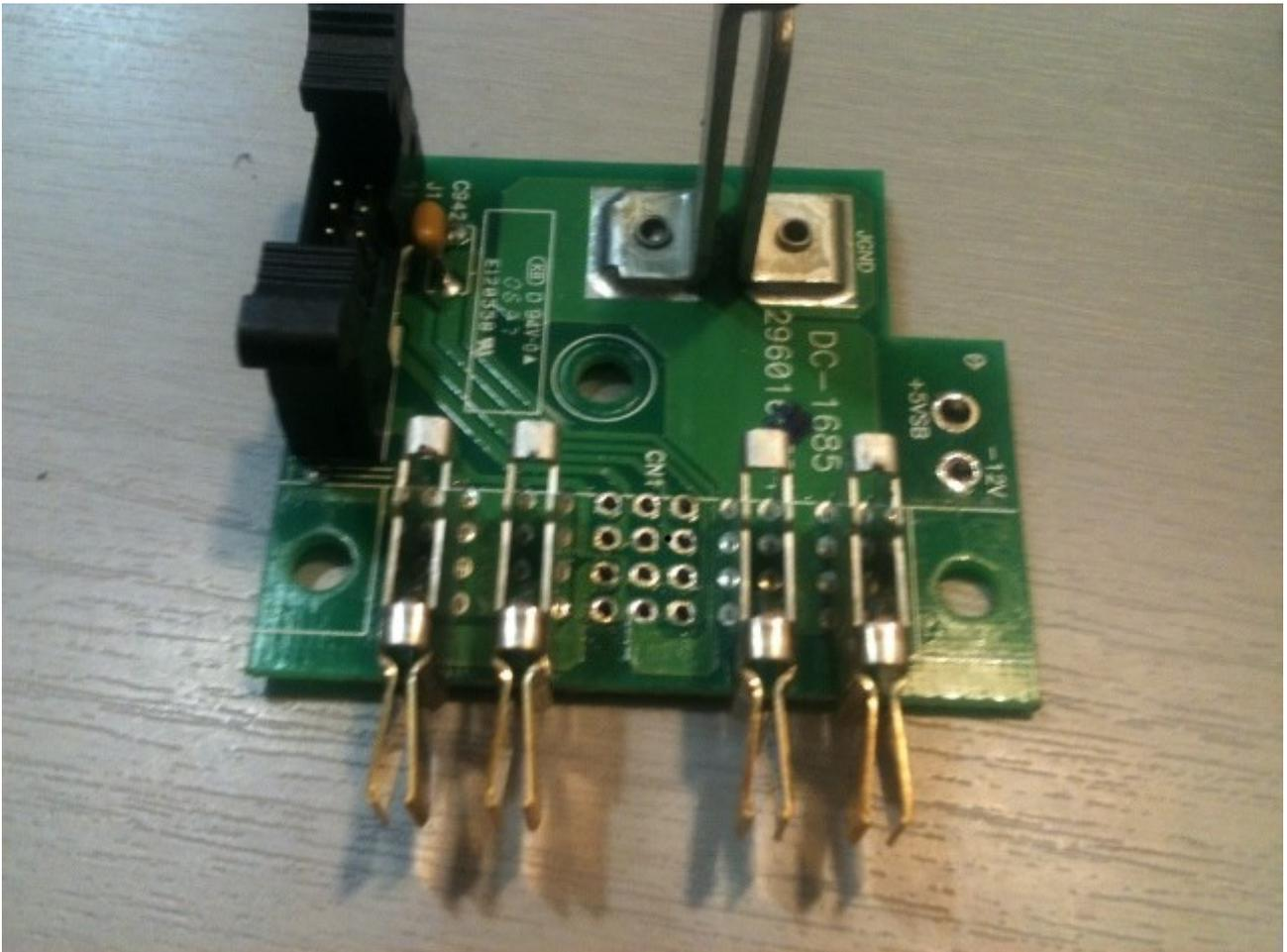
per dissaldare i pin serve un po' di calma, una volta dissaldati vanno estratti dal circuito stampato e dal connettore nero, si consiglia di farlo uno alla volta..., vi risulterà quasi impossibile sfilare i pin più un basso, poco importa l'importante è aver sfilato i 9 delle file sovrastanti.
