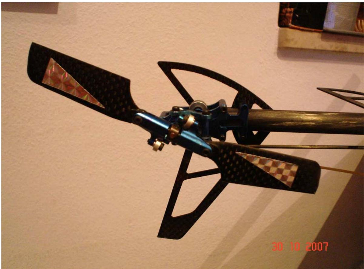
Accertatevi anche che ruotando in senso orario il gruppo della testa principale dell'Ely i palini girino in senso antiorario liberamente senza forzare (altrimenti dovrete ricontrollare la cinghia interna al tubo di coda).
