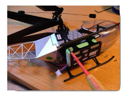
Separate il telaio dal corpo grigio in modo da arrivare alla prima ruota dentata.
