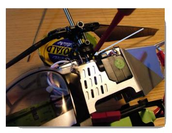
7: Rimontare la corona inferiore sostituirla nel caso che sia sgranata, e riattaccare il carrello
