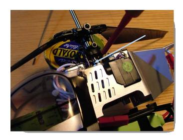
3: svitale le due viti che bloccano la corona in plastica subito sopra la fine del telaio, attenzione le due viti sono piccolissime usate un cacciavite magnetizzato per evitare di perdere le viti nei meandri del telaio.
