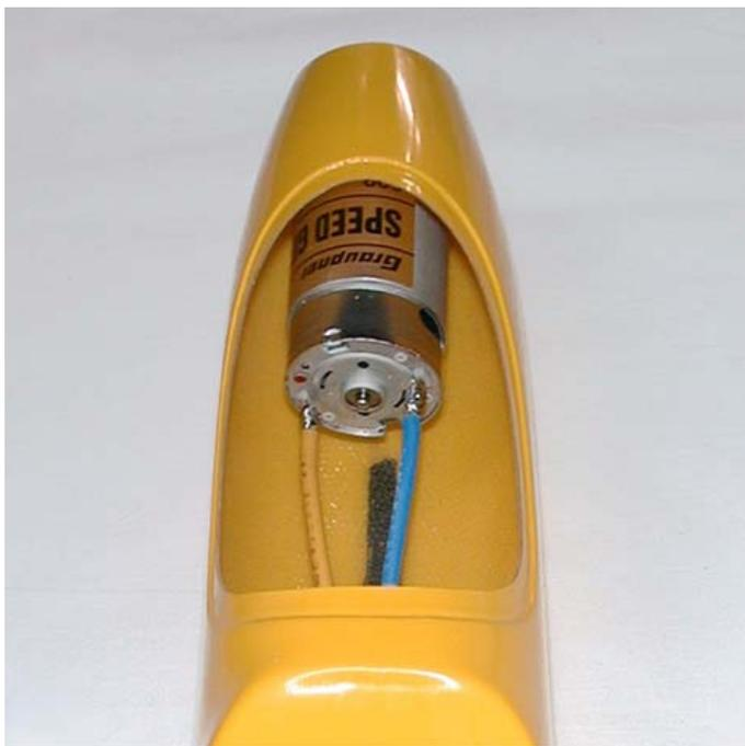
Piccole correzioni dell'inclinazione si possono ottenere avvitando maggiormente la vite di supporto del motore dalla parte in cui si vuole aumentare l'angolo.
