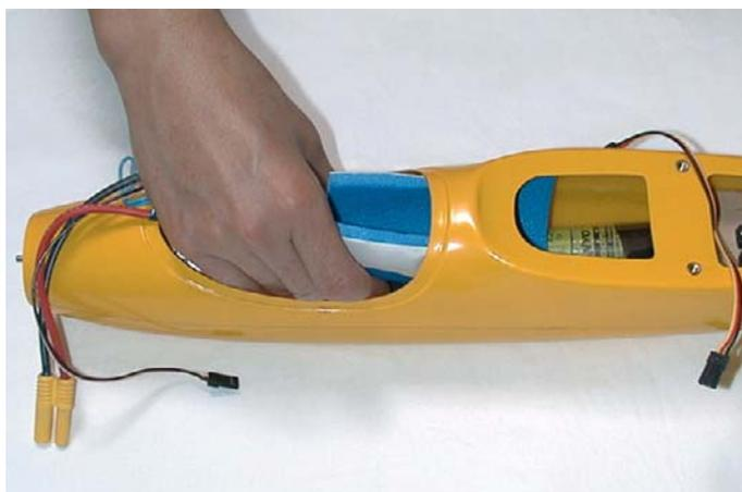
**Fig.23: Inserire il materiale di protezione.**
