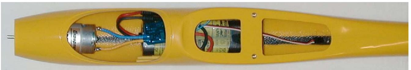
**Fig.20: Pacco batterie in posizione.**
