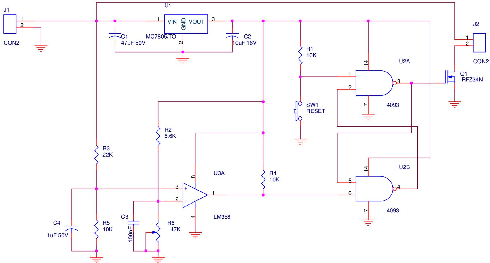
**Premendo RESET dopo aver alimentato il circuito si ha l'accensione del carico connesso a J1 appena la tensione si abbassa sotto la soglia regolata da R6 il mosfet non conduce piu' e il carico e' disalimentato**
