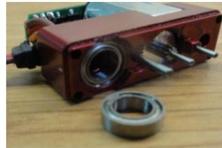
Sortie roulement protégé par joint torique.
