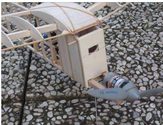
*Particolare attacco motore elettrico*
