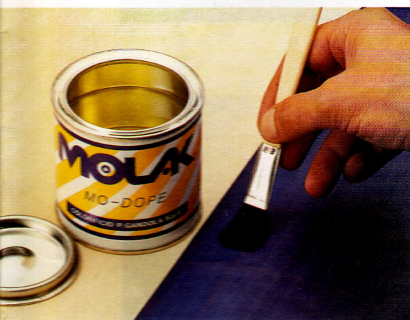
Vernice tenditela a base nitrocellulosica. Si applica con un pennello morbido a più strati.
