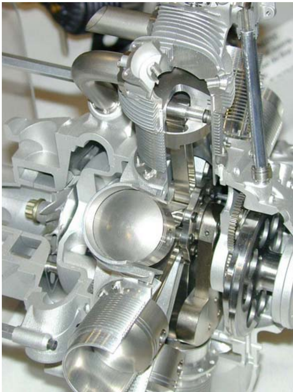
Replica sezionata del 9 cilindri Pratt & Witney Wasp
