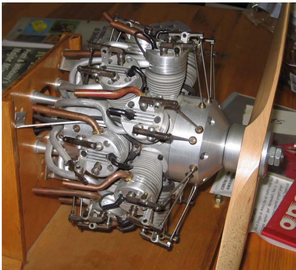
Il magnifico 14 cilindri doppia stella costruito da Lamberto Balestrazzi
