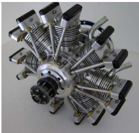
Lo splendido 7 cilindri realizzato da Luigi Spalla ispirandosi al Pratt & Whitney Wasp
