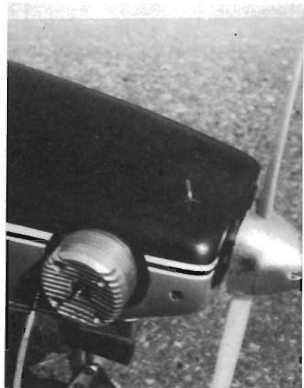
Il potente Supertigre 75 che aziona l'Airone: una motorizzazione da 15 cc permetterà il traino di modelli fino a 5 mt.
