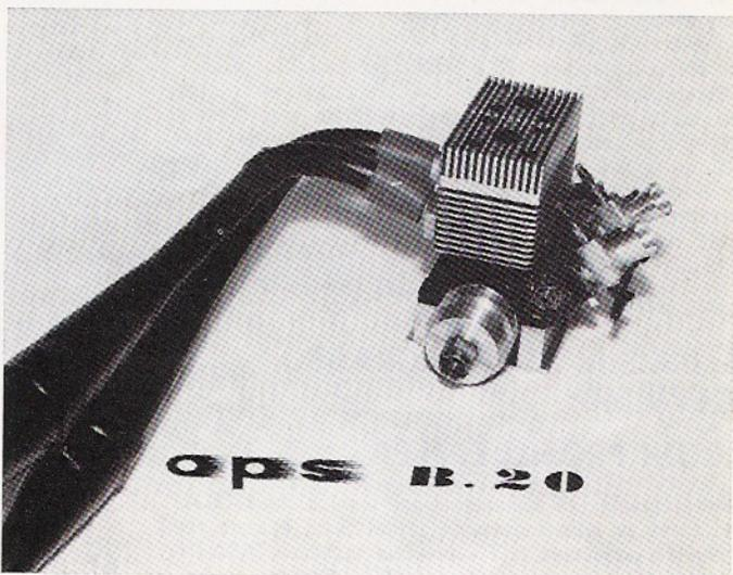
spensabile per il regime di 15 ÷ 17.000 giri del B.20. Il monoblocco è diviso in tre parti; le due inferiori combaciano lungo l'asse dell'albero a gomiti, soluzione indispensabile per un corretto alloggiamento dello stesso, la parte superiore inizia in prossimità delle luci di scarico e termina al bordo superiore della camicia, otto tiranti bloccano insieme le tre parti. Questa soluzione obbligatoria per il divertimento feriale di Gualtiero Picco che ricavò di fresa dal pieno
