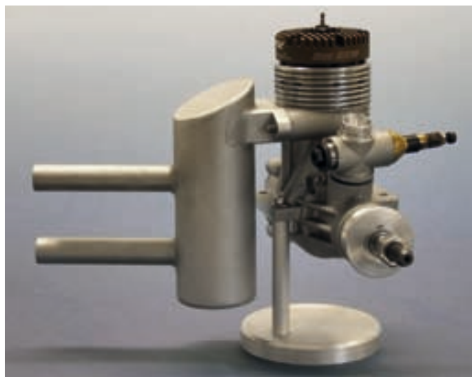
R91 mit Pitts-Style-Dämpfer
