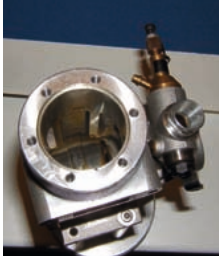
Die Überströmkanäle im Gehäuse
