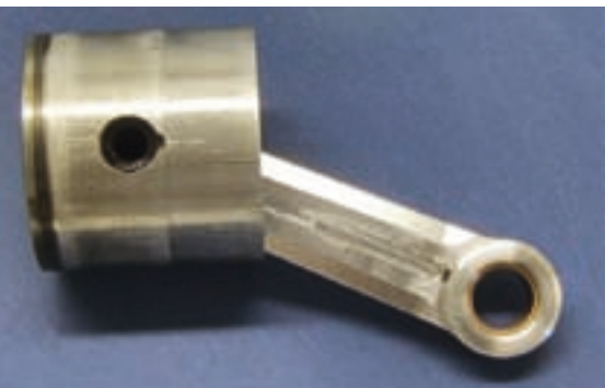
Kolben und das aufwändig gefertigte Pleuel
