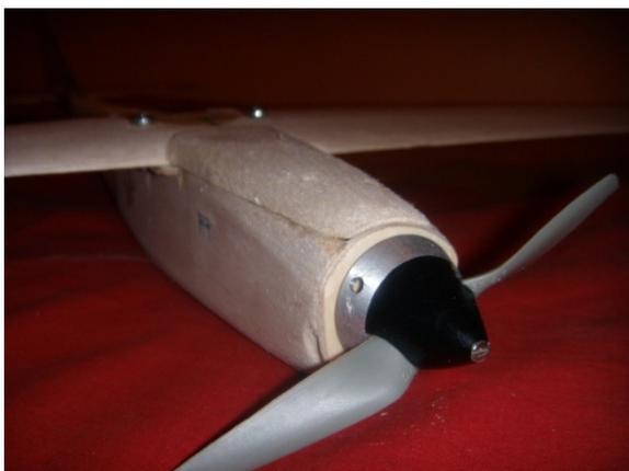
Sotto l'ogiva con un dremel potete fare dei fori per la ventilazione al quale dovete poi dar sfogo nella parte dietro l'ala con un buco di uscita.
