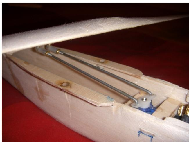
In questo modo si può avere la massima precisione con il minimo ingombro e il minimo peso e soprattutto avendo un servo solo! Garantito!
