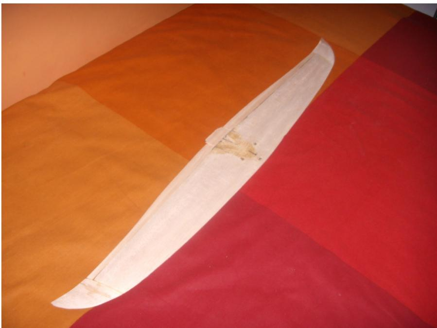
Io consiglio di partire con la costruzione dell'ala, o meglio con la sagomatura dell'ala. Dopo aver disegnato sulla tavoletta la pianta dell'ala senza le tip (vedi disegno autocad) ritagliate il tutto con un seghetto e otterrete un ala spessa a sezione rettangolare senza gli alettoni. Con i pezzi di scarto rimasti ritagliate allo stesso modo le tip in modo da mantenere le
