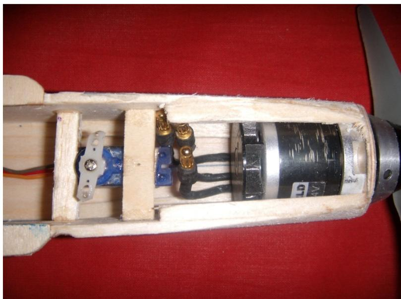
Accertatevi che il motore giri liberamente e non sfregi contro le pareti. Lo spazio è limitatissimo. Il servo che vedete subito dietro il motore è il servo degli alettoni; trasferisce il movimento mediante 2 rinvii che ogni volta che fissate l'ala vanno ad infilarsi dentro la squadretta (nei 2 forellini leggermente più grandi); il servo è messo all'incirca nell'asse del modello, dipende nella vostra precisione di come avete saldato le uni ball e come avete fatto le barre di torsione!
