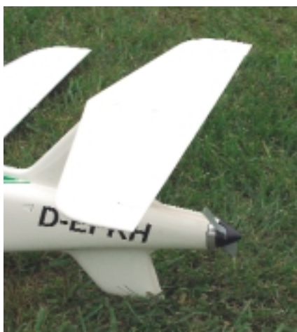
Da sinistra: un particolare del motore, montato nel cono di coda. Il modello in piena velocità ed un particolare del vano-batterie.
