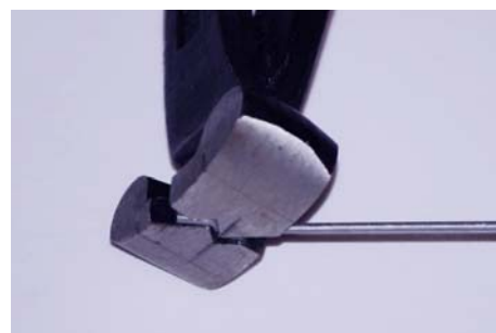
Fig.38: Piegare l'estremità dell'asta di rinvio.
