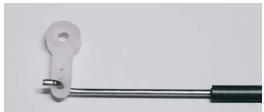
Fig.41: Montare la squadretta sull'asta di rinvio.
