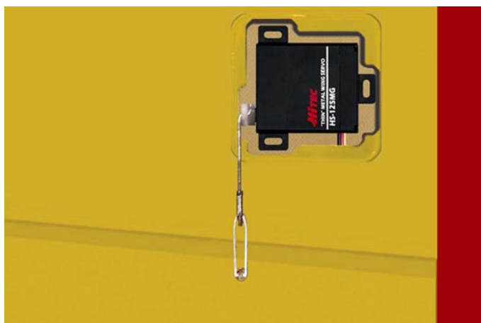
Fig.54: Asta di rinvio in posizione.
