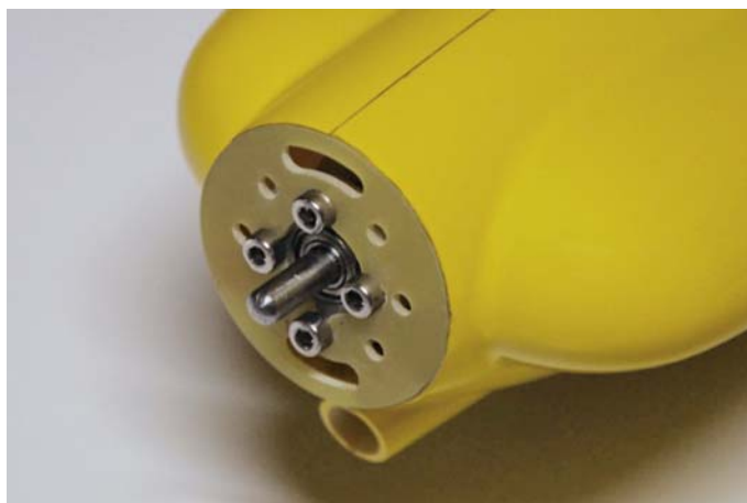
Fig.23: Avvitare il motore all'ordinata.
