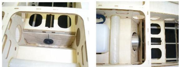
Tagliare il collettore originale, accorciandolo di 10 mm in modo da allinearlo al canister
