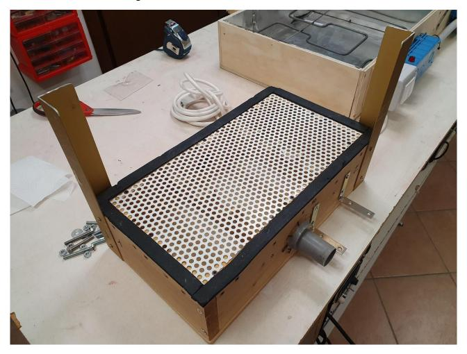
Tutto è fissato con viti e abbondantemente cosparso di silicone nelle giunture per bloccare qualsiasi perdita d'aria che renderebbe non efficiente l'aspirazione. Su un lato c'è la presa per l'aspirazione e due staffe ad "L" tramite le quali si blocca il pulsante per l'avvio del bidone aspiratutto che creerà il vuoto. La presa è un normale tubo in plastica per usi idraulici.
