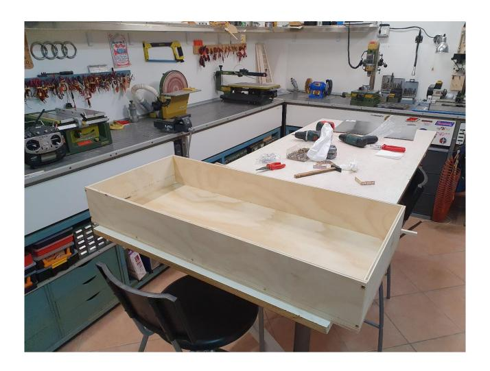
La scatola della foto è realizzata in compensato da un centimetro di dimensioni 40 x 90 centimetri.
