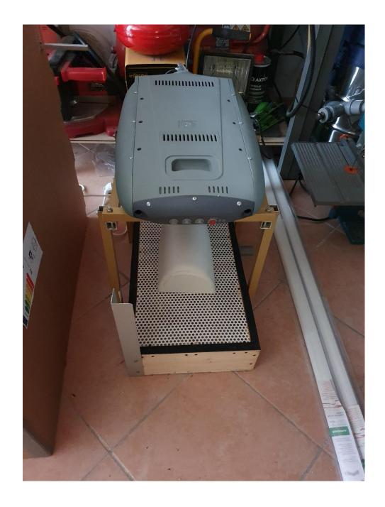
Nei vari tentativi ho cercato di scaldare i master mettendo una stufetta sopra al master sospesa con un supporto. Poi ho provato a scaldare il master nel forno di casa. Ma anche questa soluzione si è rilevata fallimentare. La stufetta si è fusa visto che per la fisica il calore sale. E il master si è spaccato quindi lo ho dovuto rifare.
