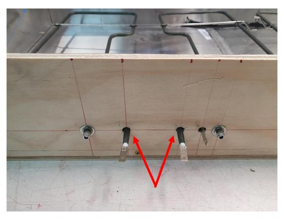
I fori in rosso sono quelli del passaggio dei due elettrodi delle resistenze. Scaldano molto e quindi ho allargato i fori oltre la misura degli elettrodi in modo che scaldate non tocchino il legno.
