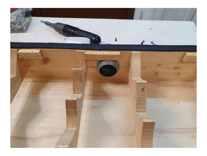
Il particolare interno del tubo per l'aspirazione.
