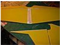
Foto5: gli scassi in cui si infileranno timone orizzontale e verticale. Mi raccomando di rispettare la perpendicolarità.
