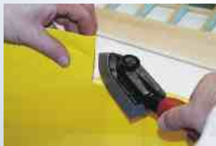
Fig. 12b piegare e fissare la copertura.
