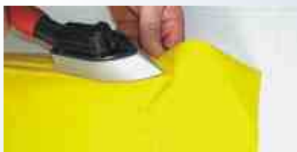
Fig. 9 / 9a Lavorare gradualmente intorno alle curve
