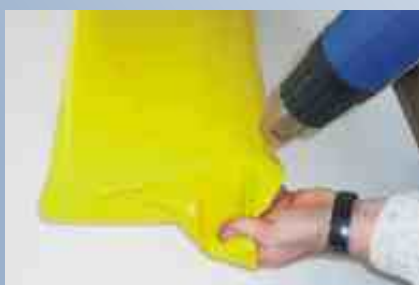
Fig. 11a-d Copertura della punta dell'ala
