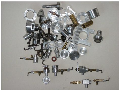
*Vari pezzi tra cui un impianto scarico per il bicilindrico ed in basso dei carburatori rc*
