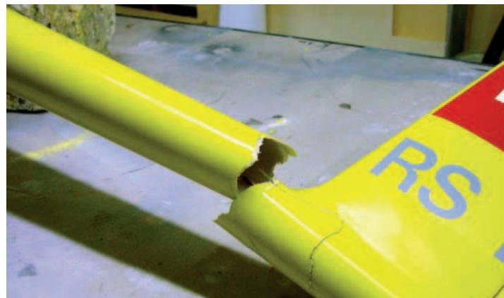
Risse im Laminat oder komplette Brüche lassen sich mit der „Plätzli-Technik“ problemlos und dauerhaft reparieren.
