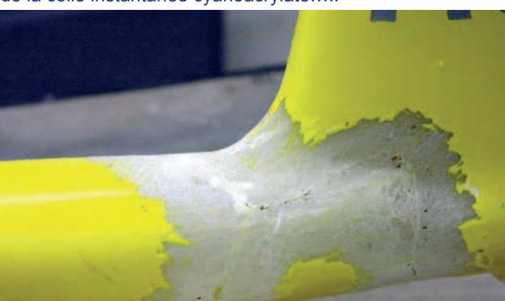
und anschliessend möglichst flach nach links und rechts verlaufend, ausgeschliffen. Es wird solange geschliffen bis....
