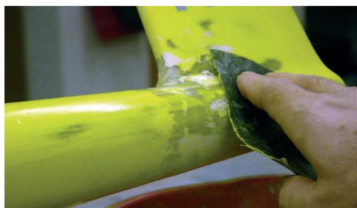
Nach dem Trockenschliff kann noch mit einem Nass-Schliff nachgearbeitet werden.
