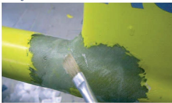
Diese „Plätzli“ werden nun mit Epoxydharz (kein 5-Min. Epoxy verwenden!) Stück um Stück aufgetragen, bis die aus-Ces “blätz” sont déposés l'un après l'autre avec de la résine époxyde (ne pas utiliser de l'époxyde 5 minutes), jusqu'à ....
