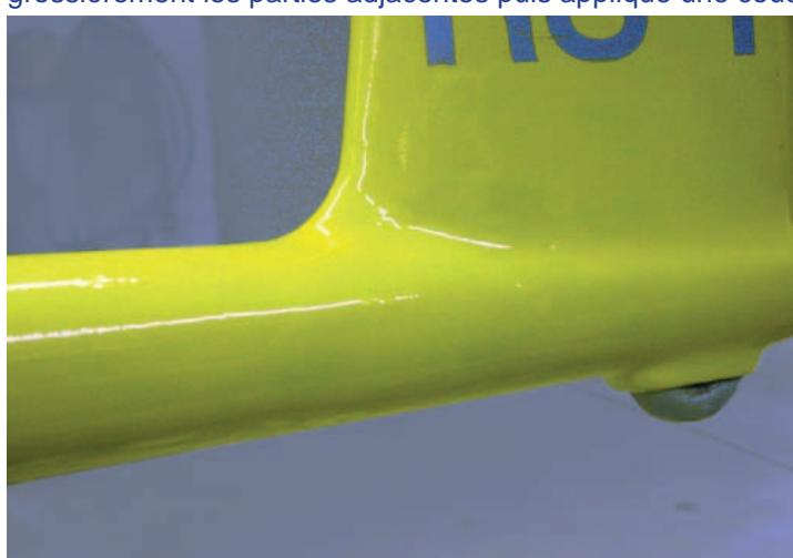
Die fertige Reparaturstelle kann sich sehen lassen. Die Reparatur dauert durch die Härtezeit des Harzes bedingt etwa zwei Abende. Die einfache Spritzpistole funktioniert nur, wenn die Luft (ca. 1,5 - 2 bar) aus einem Kompressor geliefert wird! (die kleinen Druckluftflaschen werden sofort sehr kalt und dann kommt keine Luft mehr!)
