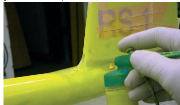
Grob abdecken, allenfalls grundieren und mit einer einfachen Spritzpistole oder Spraydose ausgespritzten.
