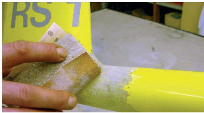
Nach der Härtung wird die Reparaturstelle vorerst mit einer Zinnraspel (Spengler- oder Klempnerbedarf) grob geschlichtet und mit Schleifpapier geschliffen.
