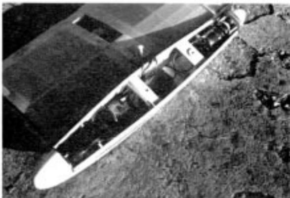
La fusoliera aperta mostra il pacco batterie, la ricevente, l'interruttore elettronico e il motore. I due servi sono montati nelle ali.
