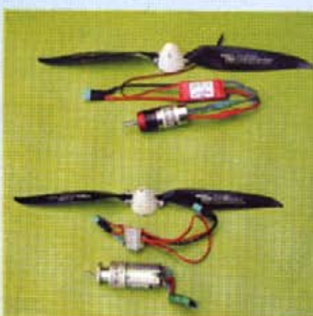
Oben: Kontronik FUN 400-28 und Getriebe 5,2:1 mit 5-mm-Welle, Aeronaut-Propeller 15 x 13 Zoll. Unten: Graupner-Speed 400/6V, Getriebe 3,8:1 mit 4-mm-Welle, Aeronaut-Propeller 13 x 8 Zoll
